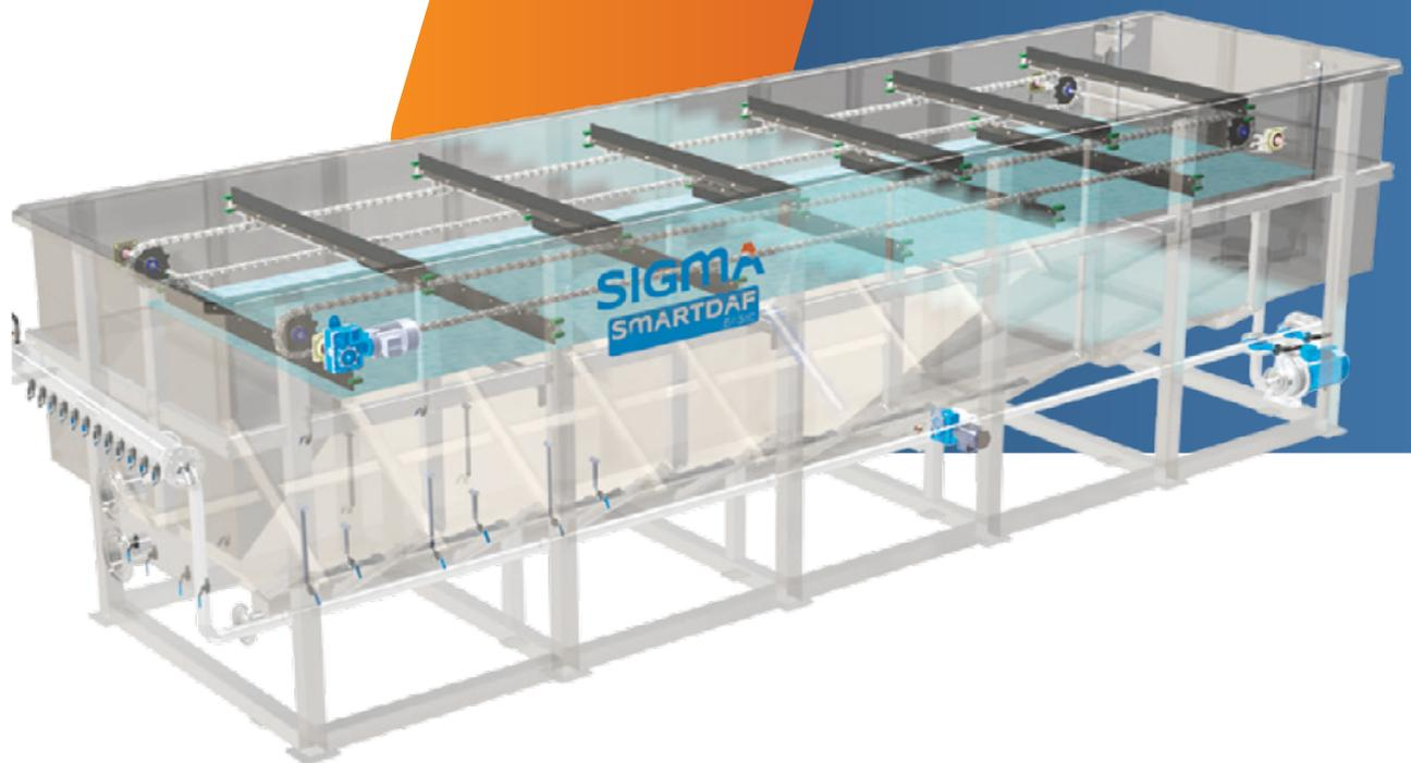
El sistema SIGMA BIODAF - FBR (flotation biological reactor), utiliza la flotación para separar el fango activado del agua y alcanzar muy altas concentraciones de biomasa en el reactor biológico, de hasta 9000 mg/L MLSS. Caudales de 50 a 10000 m<sup>3</sup>/día.
